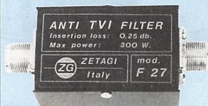
socles SO 239 sont montés sur les deux côtés du filtre. Susceptible d'encaisser une puissance allant jusqu'à 300 W (selon son constructeur !), le F 27 anti-TVI Filter ne génère qu'une perte d'insertion d'à peine 0,25 dB. Un dispositif anti-QRM qui peut parfois venir à bout de graves nuisances, pour seulement 124 F.
