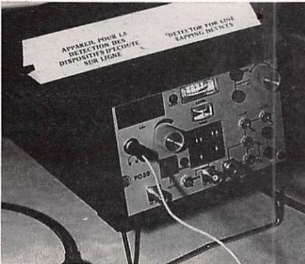
Un appareil de mesure servant à détecter la présence sur une ligne téléphonique d'éventuels systèmes d'écoute.
