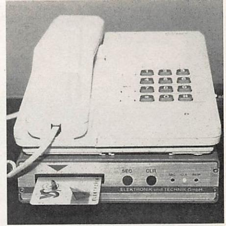
Un téléphone avec son interface de cryptophonie mettant les communications à l'abri des indiscrets, pour peu que les deux interlocuteurs possèdent de semblables codeurs-décodeurs.
