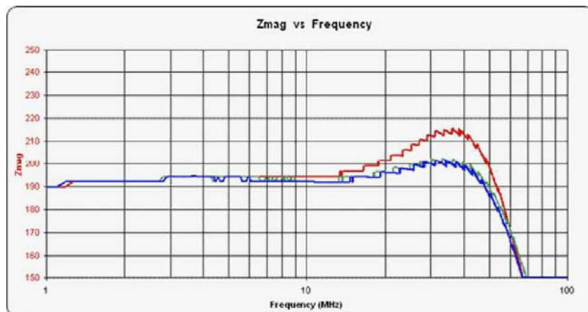
Graphe Zmag vs Frequency : Courbe bleu – coax 50Ω Courbe vert – coax 75Ω Courbe rouge – coax 95Ω
