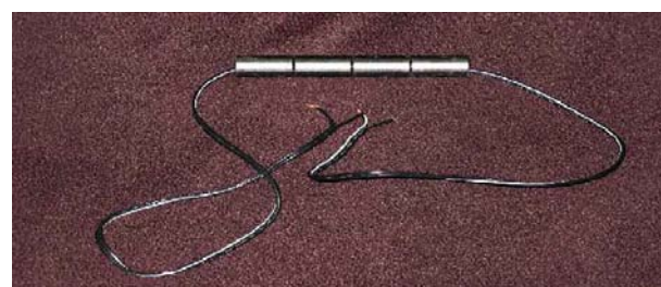
- Courbe bleue – longueur d'une paire de fils « en 8 » connectée comme un Ruthroff 4:1 enfilé au travers des noyaux de ferrite
