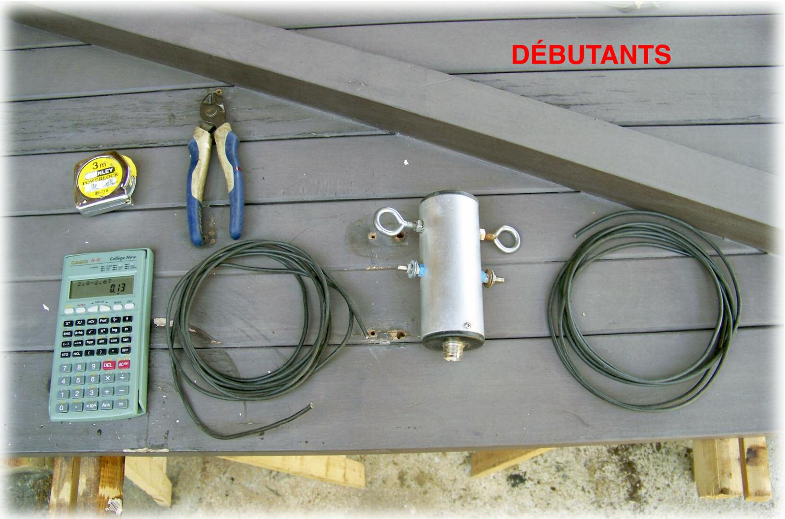
Voici tout le petit nécessaire pour réaliser une antenne dipôle
