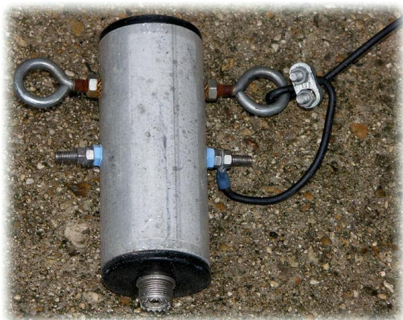
Vue du balun ITA 1/1 ou 1,5/1 de Radio DX Center proposé par RADIO 33. Cet élément permet, non seulement de ramener la symétrie du dipôle vers l'asymétrie du câble coaxial, mais aussi, de transformer l'impédance du dipôle vers celle du transceiver.
