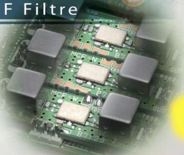
Equipé de 3 « roofing filters » : 3 kHz, 6 kHz et 15 kHz !
