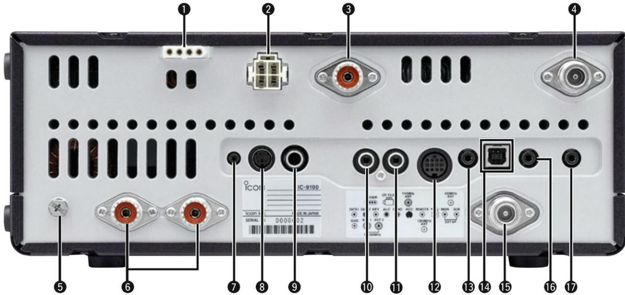
**ATTENTION aux connecteurs sommairement fixés au châssis : 1, 2, etc. Ne pas trop forcer dessus.**
