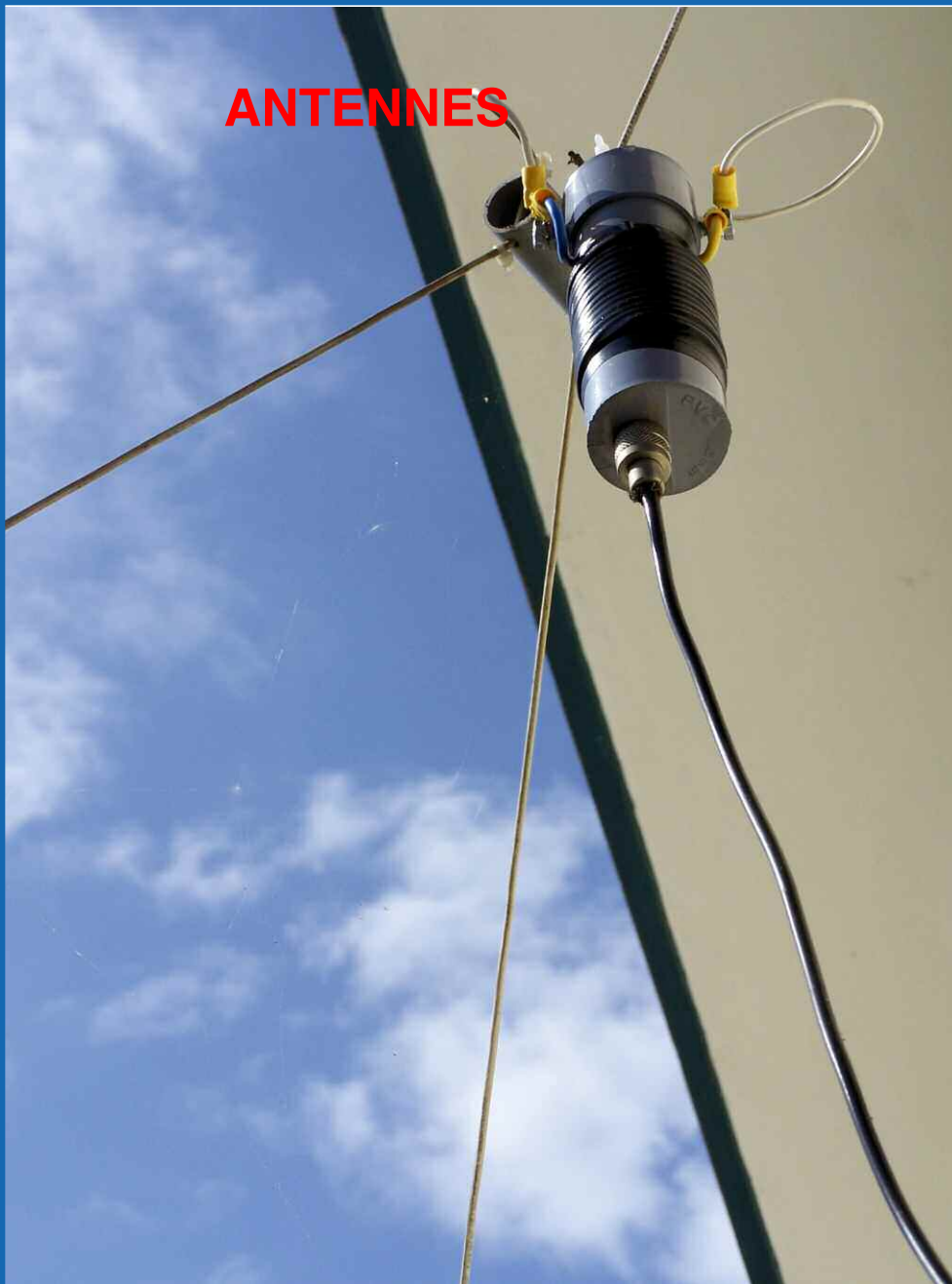
Vue du balun et de la pointe de l'antenne
