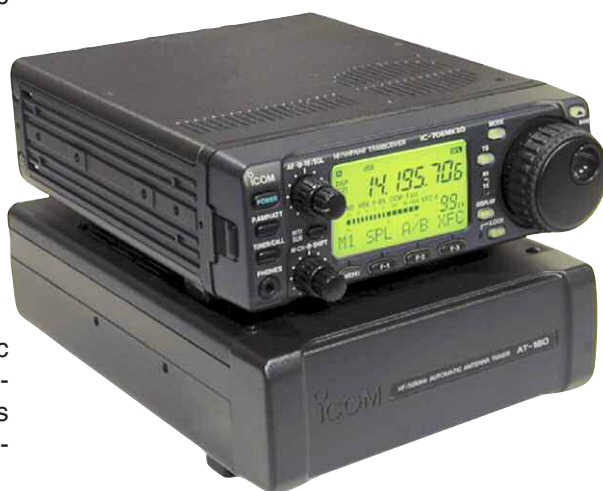
Ci-dessus, les fusibles sont des modèles en verre. Ci-dessous, la boîte d'accord externe AT-180 avec un IC-706. Cette boîte s'accommode parfaitement de nombreux transceivers de la marque, dont le IC-7200.
