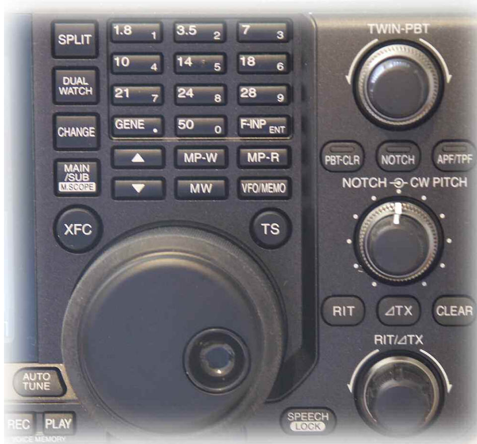
La partie gauche du poste regroupe des fonctions devenues essentielles en ondes courtes, le PBT et le NOTCH. Très efficaces ici.
