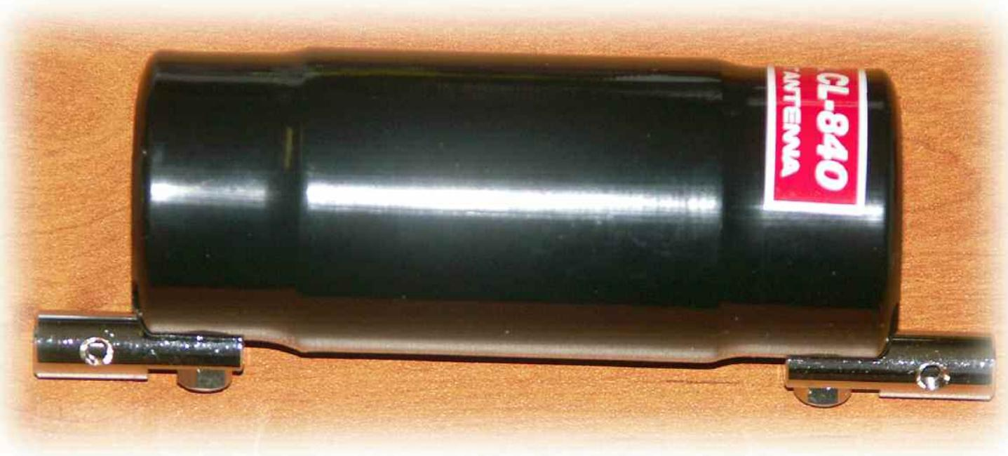
La trappe apporte une solution mécanique pratique, car, contrairement à l'interrupteur ou à l'isolateur, la trappe laisse passer le courant en dehors de sa fréquence de résonance. Dans notre exemple, la fréquence de résonance devra être de 7 MHz ce qui permet aux extrémités de jouer correctement leur rôle sur 3,5 MHz.
