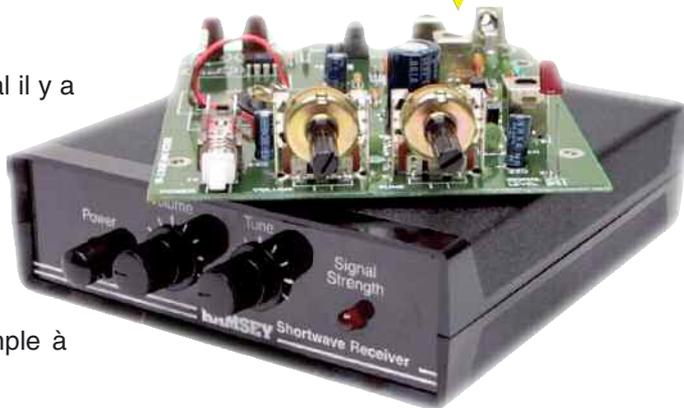
En suivant la notice avec rigueur rien ne peut se passer de contrariant pour arriver au terme de la réalisation, il n'y a aucun composant microscopique. La conception de base prévoit une couverture dans la plage de 4 à 20 MHz et lors de vos réglages vous pourrez choisir n'importe quelle portion de 2 MHz dans cette intervalle. Ramsey propose aussi des kits plus spécialisés dans la radio d'amateur.
