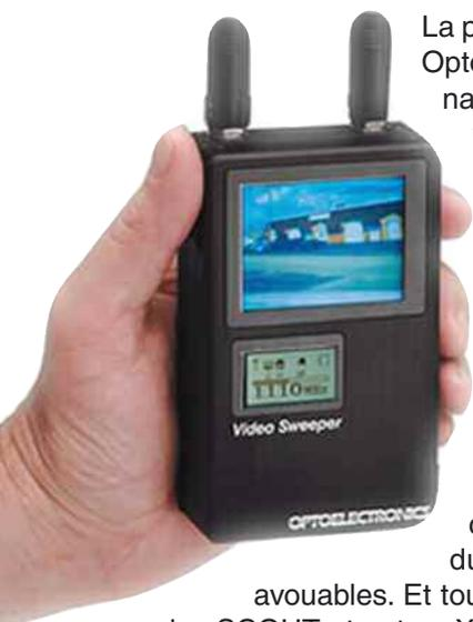
La prolifération de micro caméras à 2,4 GHz à des fins plus ou moins légales a fait naître chez Optoelectronics ce détecteur. Il est équipé d'un écran TFT couleur de 2,5 pouces de diagonale. D'après le fabricant il ne faudrait que 15 secondes à leur détecteur pour trouver et se verrouiller sur la fréquence d'émission.
