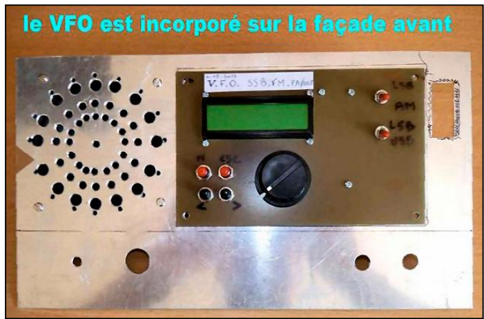
VFO implanté sur époxy simple face
