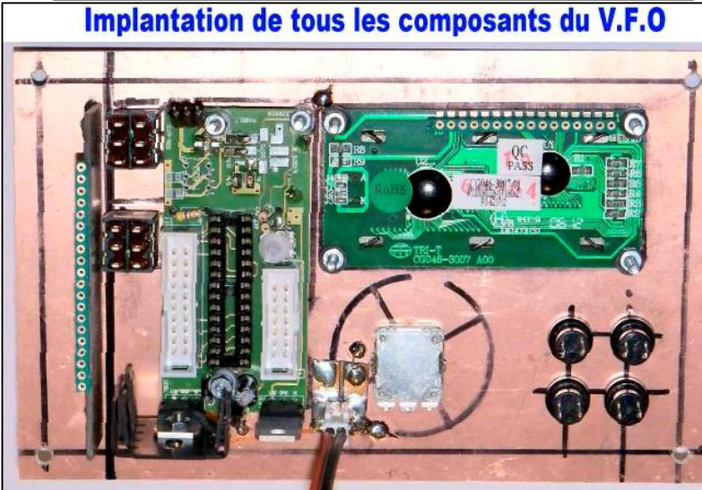
VFO finalisé sur façade avant
