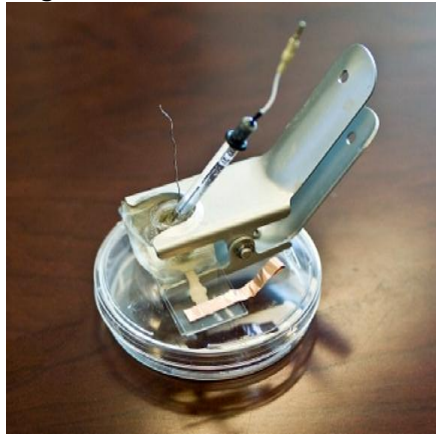
Cette version de la cellule photoélectrochimique, qui a été utilisée pour les tests de laboratoire, contient une solution de produits photoactifs (dans un cylindre de verre maintenu en place par une pince en métal) avec deux électrodes en saillie à partir du haut, une en platine (le fil dénudé) et l'autre d'argent (dans un tube de verre). Photo: Patrick Gillooly
