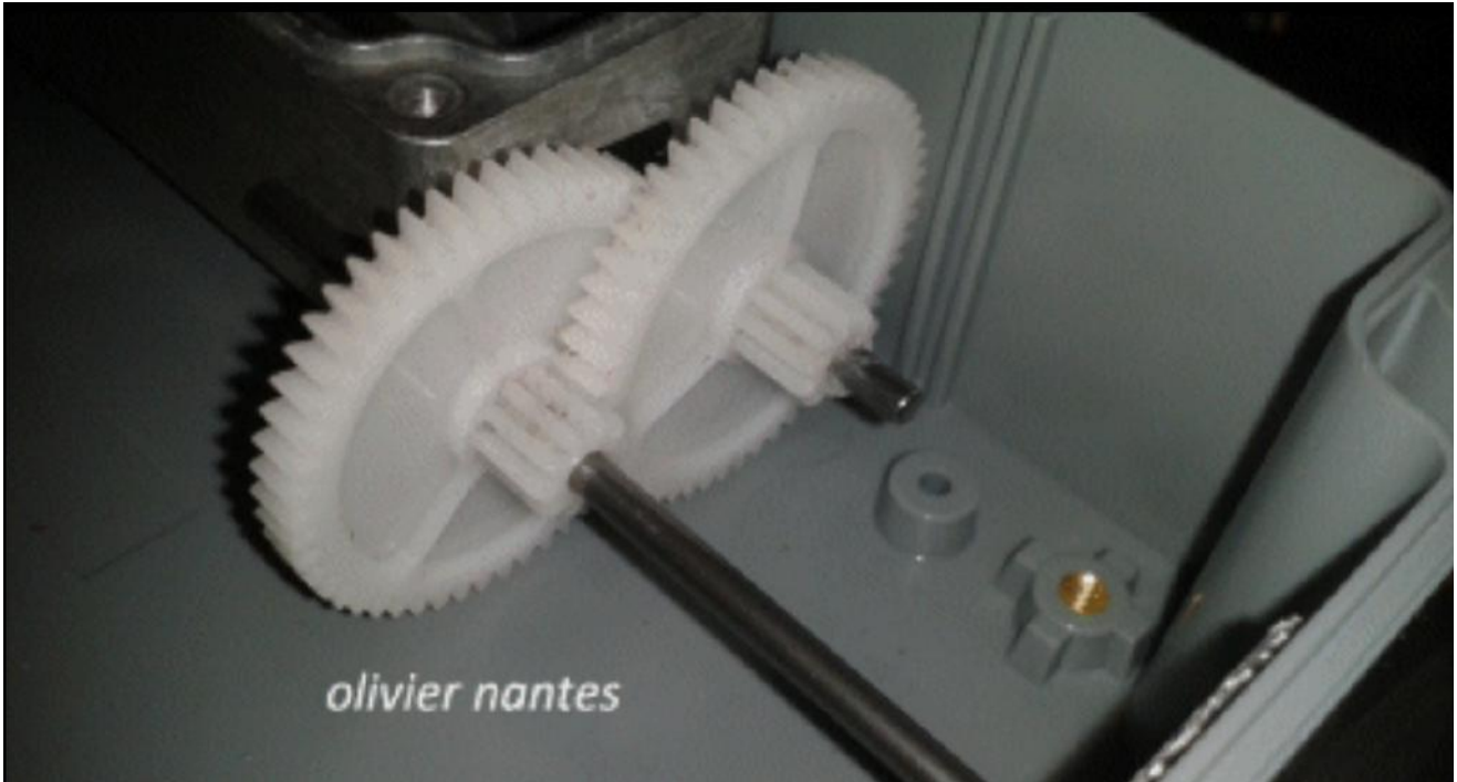
Pignons en plastique et axe en acier récupérés sur des lecteurs cd d'ordinateur
