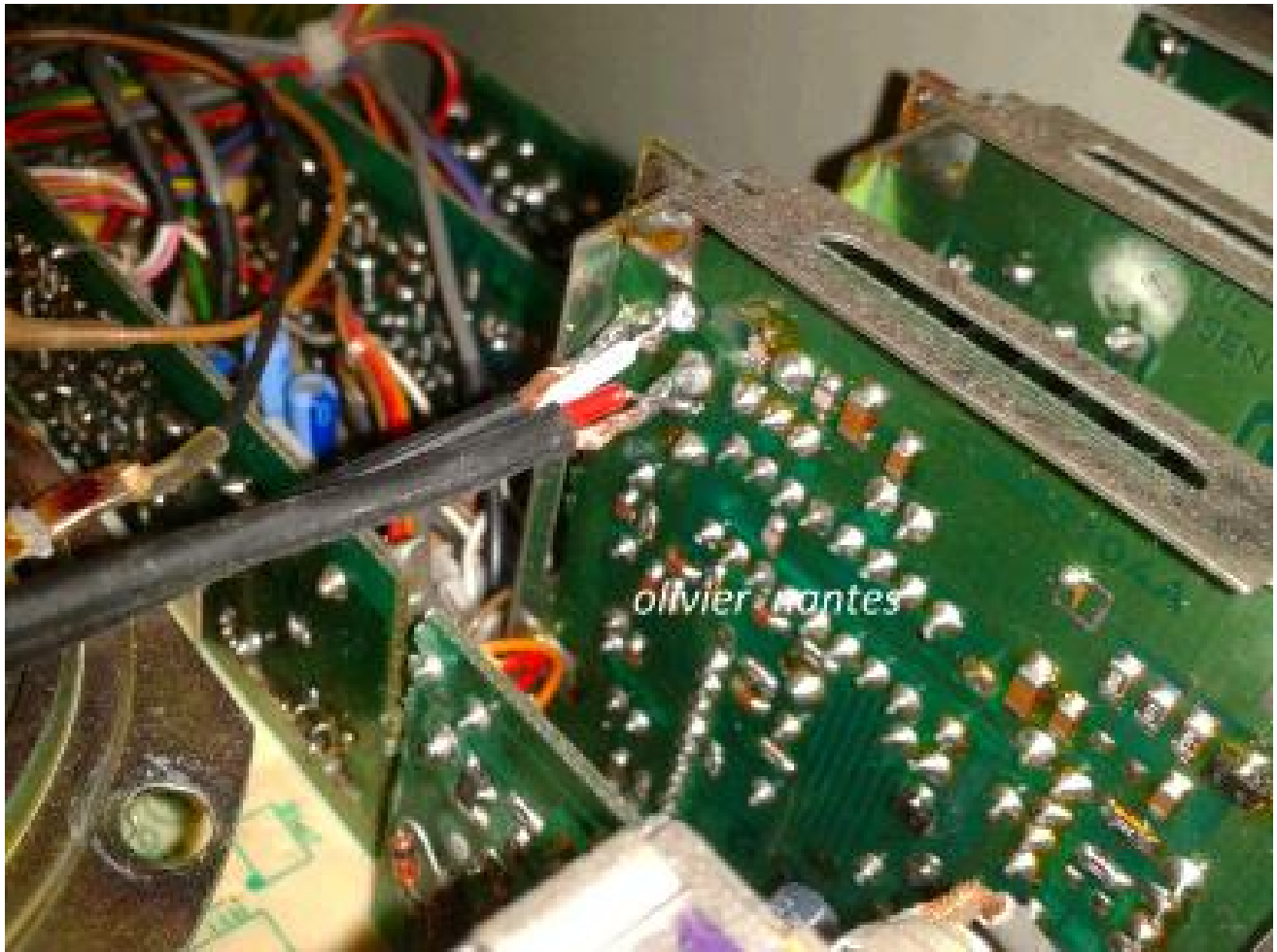
Dessoudage du condensateur et soudure des câbles blindés qui vont sortir du boîtier et venir dans le boîtier extérieur en alu blindé
