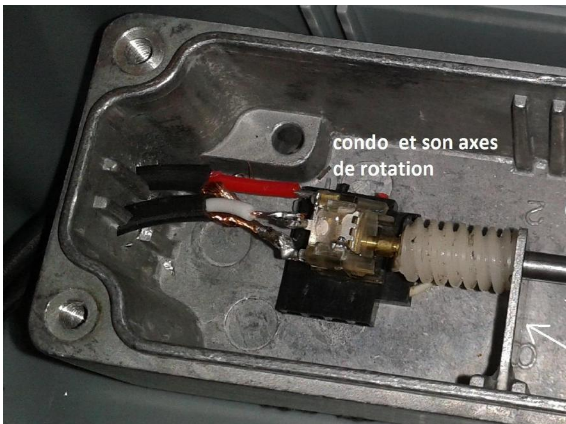
Boîtier en alu contenant le condo et les pignons de rotation dans la boîte en plastique
