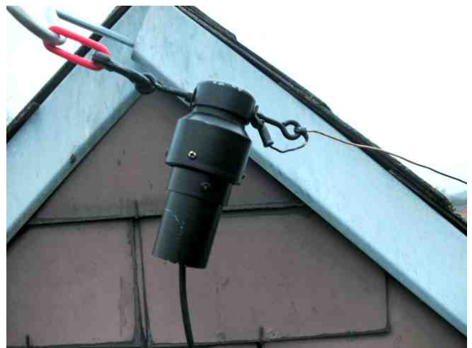
Le "magnetic balun" dans son boîtier raccordé à la "pipe" par une chaîne en plastique
