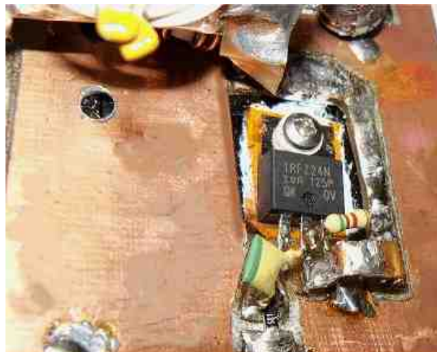
Sur cette photo le IRFZ24N est bien visible, une manière incontournable de confirmer la suite de l'expérimentation sur l'amplificateur STRONG-V2
