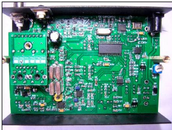
Vue intérieure du MFJ-9200 avec la platine embrochable bande par bande à gauche du filtre à 4 quartz
