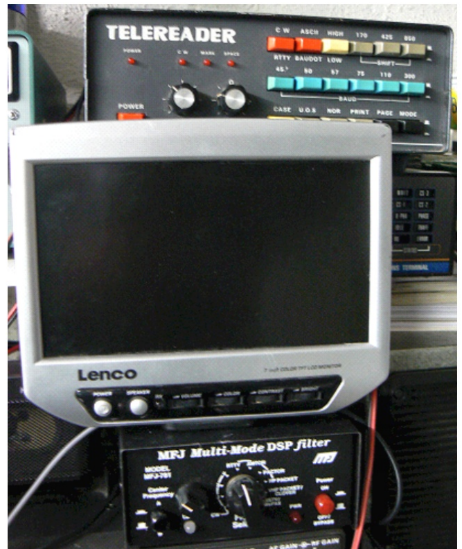
Le Telereader CWR670E, un écran TFT pour lecteur DVD et le DSP MFJ-781. On peut même utiliser le HP du moniteur !
