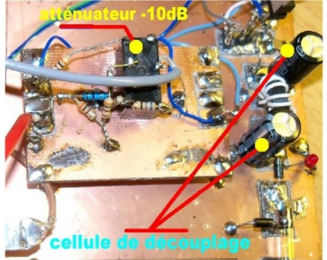
La cellule de découplage 2 x 1000µF et 10 spires Ø 1mm sur tore 50-43 ou anti - parasites jaune
