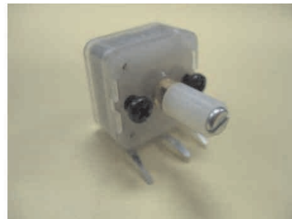
Condensateur variable polyvaricon en plastique à 2 cages d'une valeur de 100 à 150 pF (récepteurs pocket)
