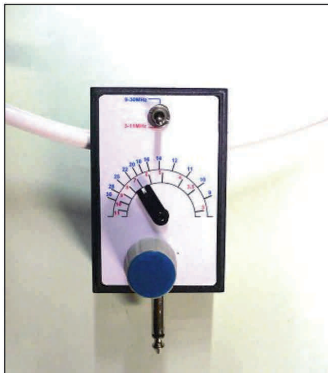
Notre CV comporte un démultiplicateur, d'où le bouton décentré.
