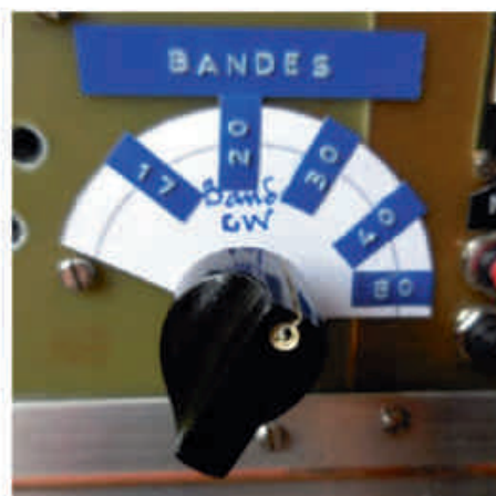
Commutation commune filtres de bandes et passe-bas
