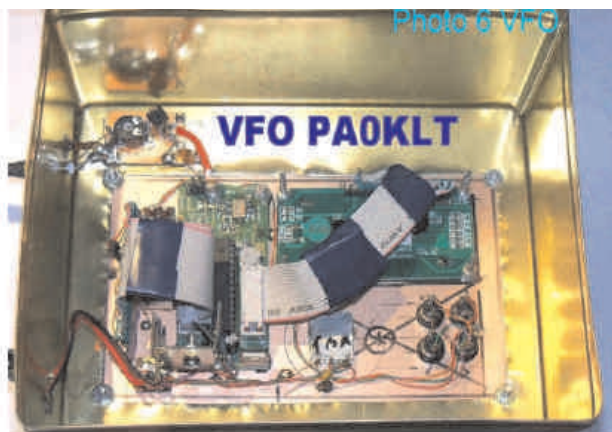
Ces 2 photos sont un exemple de montage du V.F.O. de PA0KLT qui a équipé le prototype du DEO 2 SSB lors des 1er essais.
