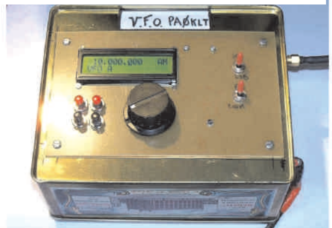
Ces 2 photos sont un exemple de montage du V.F.O. de PA0KLT qui a équipé le prototype du DEO 2 SSB lors des 1er essais.
