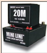
Toujours à Dayton, SGC présentait le Mini Lini™, un étonnant amplificateur linéaire extrêmement compact (il tient dans la main) avec alimentation incorporée. C'est un monobande, à modules interchangeables (il est fourni avec le module 14 MHz). Les modules optionnels couvrent les bandes 160, 80, 40, 17 et 15 m.
