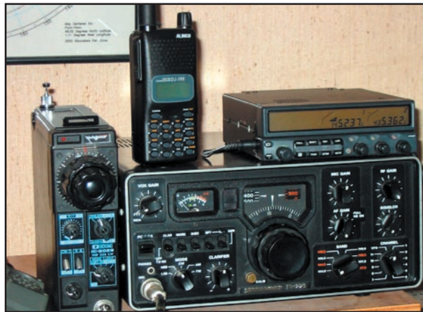
Photo 1: Quelques matériels VHF: De gauche à droite, l'Icom IC-202 (uniquement BLU/CW). Un petit portable pour le trafic FM Alinco DJ-195. Un bibande 144/430 FM, le Kenwood TM-742. En dessous, un vénérable Sommerkamp FT-221 (BLU, CW, FM)...
