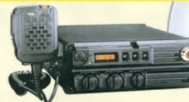
VX-1210 Emetteur/récepteur HF portable 500 canaux — 20 W
