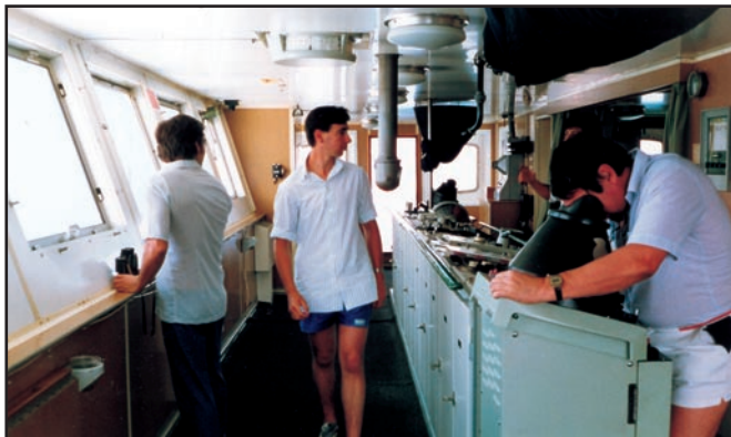
Photo 2 : Relèvement au radar, distance des côtes, pour effectuer le changement de route.
