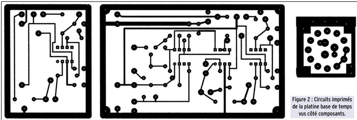
Figure 2 : Circuits imprimés de la platine base de temps vis côté composants.
