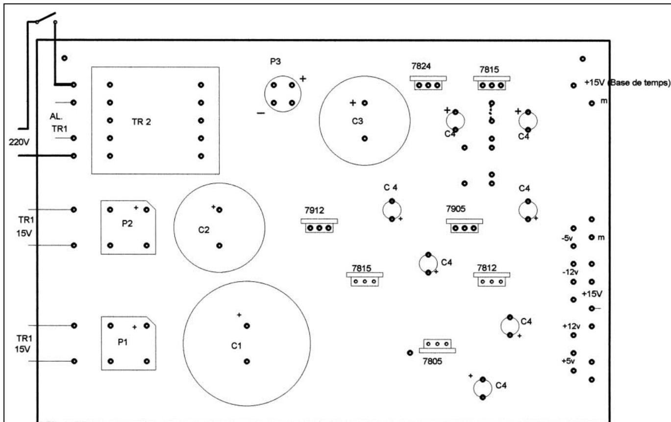
Figure 1 : Implantation de la platine alimentation.
