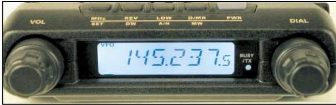
L'afficheur LCD. Au-dessus les 5 touches de commande.
