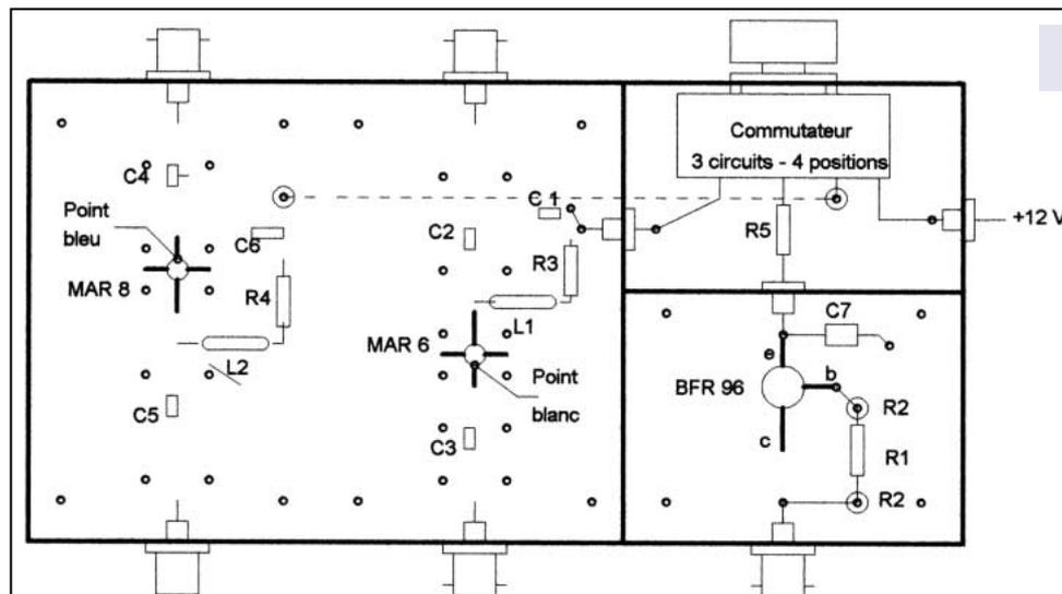
Figure 8 : Implantation du Générateur de bruit et des amplificateurs large bande.
