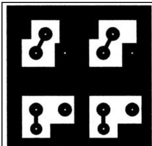
Figure 7 : Circuit imprimé des marqueurs 10 MHz - 50 MHz.
