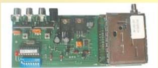
Caractéristiques communes : platines montées et testées, alimentation 13,8V sortie audio (6,0 et 6,5MHz modifiables en 5,0 ou 5,5 MHz) et vidéo sur FCA, sortie HF sur SMA femelle, fréquences fixes (1255, 1250, 1265, 1286,5, 1247, 1282,5, 1279,5MHz).
