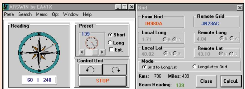
alors décider de faire tourner l'antenne automatiquement. Une rose des vents montre la rotation de l'antenne. Le logiciel gère le long path et le short path. On peut choisir une fenêtre d'affichage dédiée aux contrées DXCC, avec zones ITU, CQ, informations sur le décalage UTC, les heures de lever et coucher du soleil, etc. ou une fenêtre plus orientée vers le trafic V/UHF avec les locators (et distance azimut) des correspondants.
