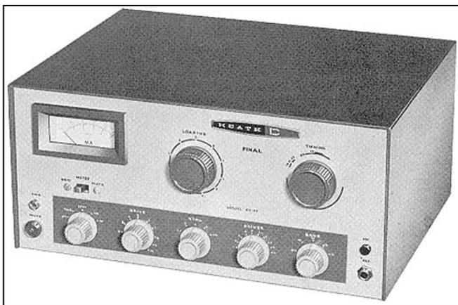
Emetteur Heathkit DX 60. Exclusivement bandes amateur, piloté quartz ou VFO extérieur, 3 étages à lampes, final avec une 6146, 60 W HF, CW et AM. Correspond au classique montage qui devait être construit, réglé et... compris par les candidats à la licence amateur.
