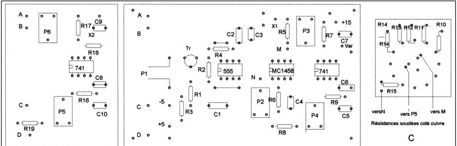
Figure 2 : Implantation de la platine base de temps.
