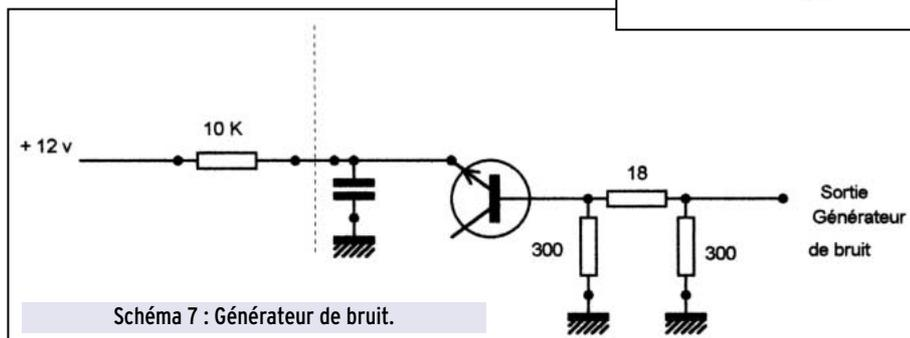
Cet appareil relativement simple facilitera le réglage de nombreuses réalisations: oscillateurs, filtres, etc. Certains regretteront qu'il ne couvre pas, en continu, 0 à 500 MHz voire plus, mais les bandes HF, VHF (144 MHz), UHF et en particulier les harmoniques 2 et 3 du 144 MHz sont observables.
