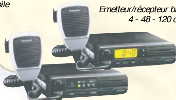
FTL-1011/2011/7011 Emetteur/récepteur bande basse/VHF/UHF mobile 12 - 24 canaux
