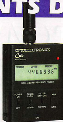
CUB Fréquence portable. 1 MHz à 2,8 GHz
