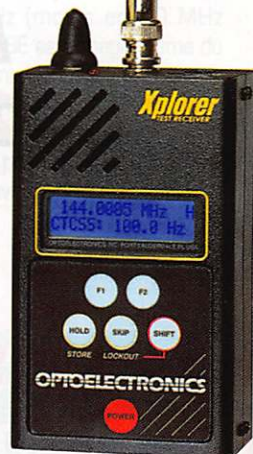
Captur d'émissions FM proches. XPLORER 30 MHz à 2,6 GHz. Caractéristiques du signal
