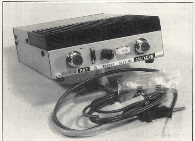
La face arrière et les câbles alimentation et antenne. Remarquez le fusible de recharge...
