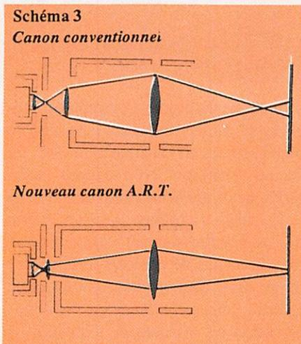
Grâce à une amélioration de la lentille de préfocalisation, les aberrations s'auto-compensent partiellement et la taille du spot électronique peut ainsi être réduite, d'où une meilleure définition de l'image sur l'écran.
