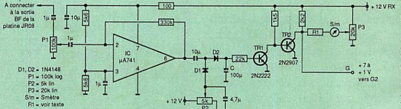
Figure 4 : C.A.G. Commande automatique de gain
