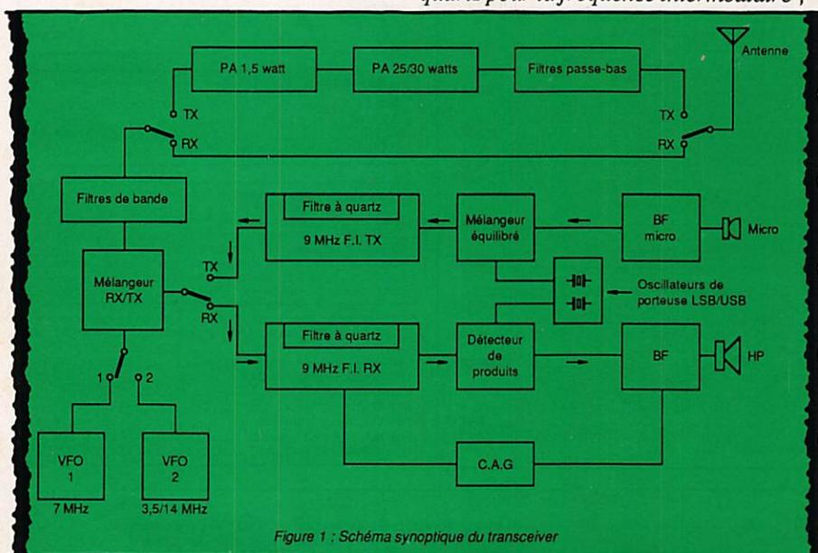
Figure 1 : Schéma synoptique du transceiver
