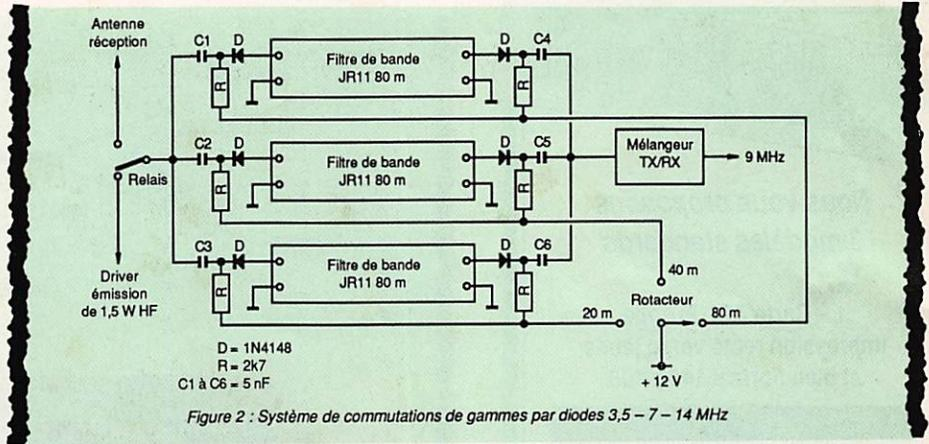
Mais pour un transceiver nous craignons quelques pertes dues à l'insertion de diodes de commutation. En fait l'expérience prouve qu'elles sont négligeables, pour la simplicité du système et les résultats obtenus. Un simple rotacteur plastique trois ou quatre positions fait l'affaire. Les filtres J.R. sont soudés sur une plaquette d'époxy servant de plan de masse aux diodes de commutation avec liaison base-impédance 50 Ω par câble coaxial miniature diamètre 3 mm.
