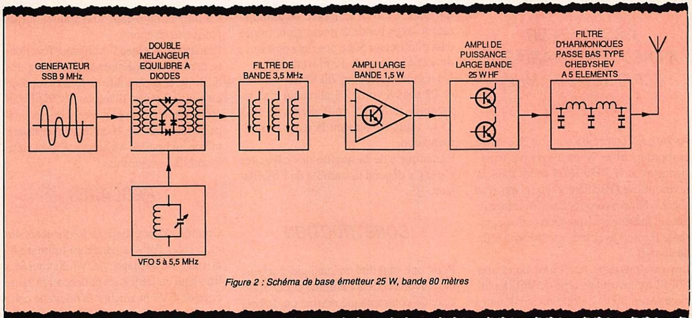
Figure 2 : Schéma de base émetteur 25 W, bande 80 mètres
