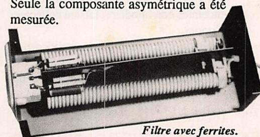
Les selfs se comportent vis-à-vis de la HF comme des résistances élevées. Les condensateurs forment des courts-circuits HF. Ils seront à fort isolement (3,5 kV). Les selfs sont réalisées sur des ferrites et avec du fil de fort diamètre.
