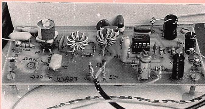
PHOTO 5 - Mélangeur-amplificateur JR08
