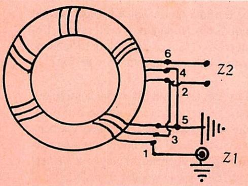
te type tore 4C6 permet d'obtenir une large bande et un très bon rendement. Il sera installé au centre du dipôle. Dans le cas d'une antenne Yagi (beam), le boîtier sera fixé sur le boom.
