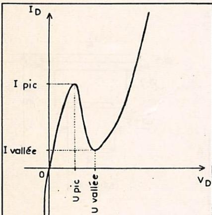
Figure 16 : Caractéristique de la diode tunnel
