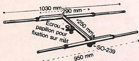
HB 9 CV standard : les 4 brins de dévissent pour un gain de place et une facilité de transport.
