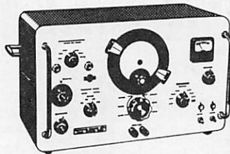
Générateur HF Métrix 931 - 50 kHz à 50 MHz - sortie HF 1  $\mu$ V à 0,1 V — 1 100 F
