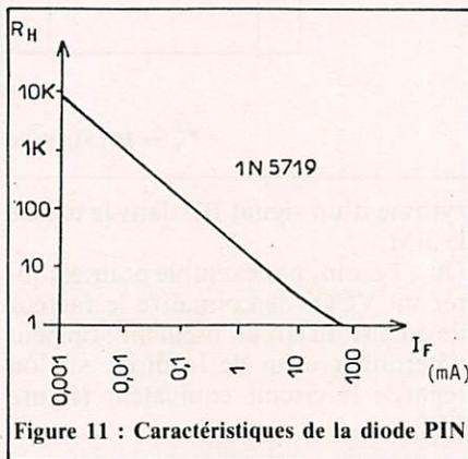
Figure 11 : Caractéristiques de la diode PIN
