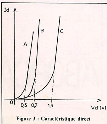
manium. La tension de seuil  $V_s$  (prolongement de la partie rectiligne de la caractéristique) est de  $\approx 0,3$  V, pour le silicium (B)  $V_s \approx 0,7$  V et pour l'arséniure de gallium (C)  $V_s \approx 1,3$  V. Reprenons notre diode et maintenant inversons le sens du générateur de tension (figure 4). Dans ce cas, la tension appliquée élève la barrière de potentiel et le courant inverse est extrêmement faible, la jonction est bloquée. La caractéristique résultante (figure 5)
