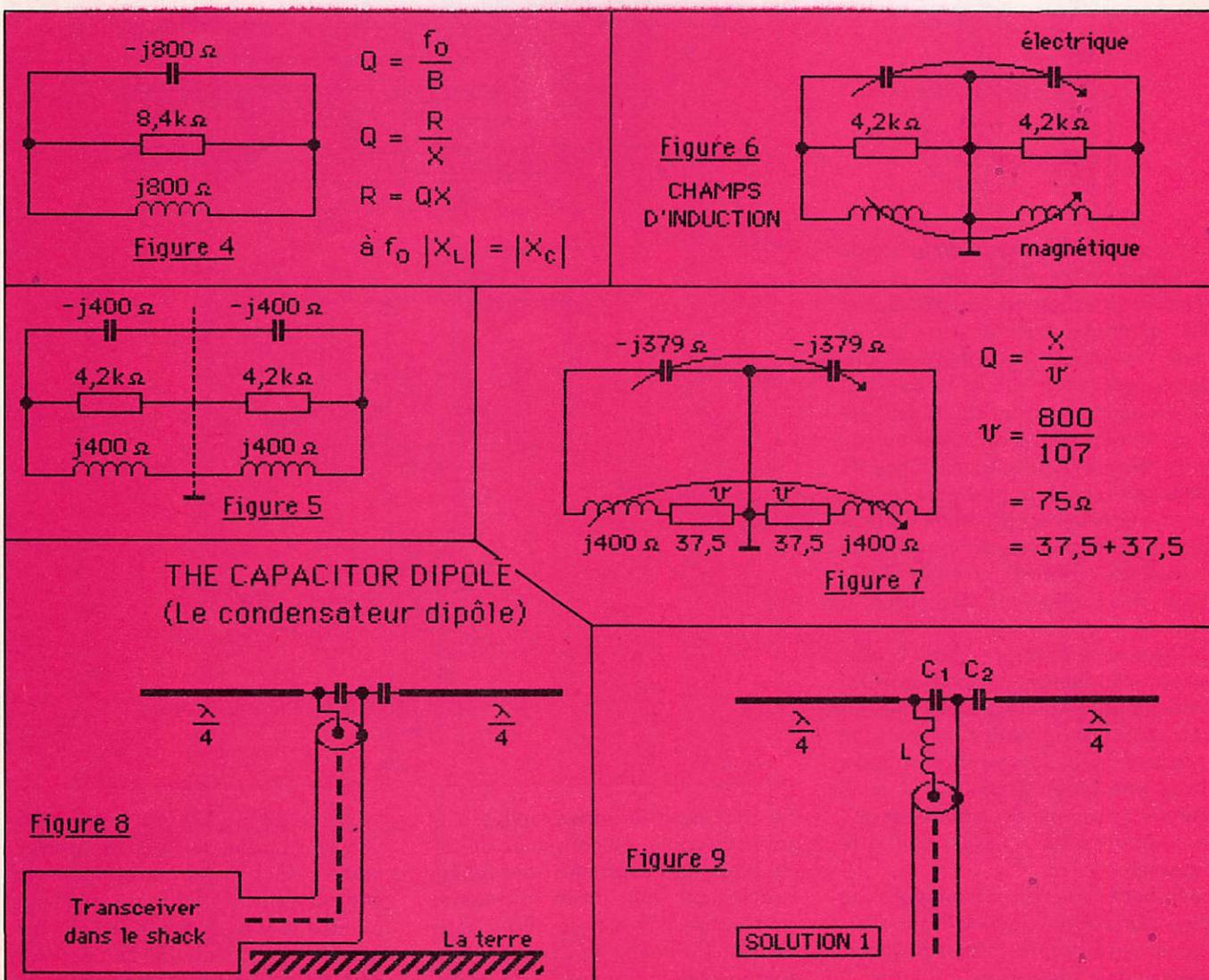
En émission, le TOS minimum est de 2 au centre de la bande et la réactance capacitive de valeur  $j42$ .
