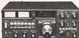
**YAESU - FT 980.** Transceiver décimétrique couverture générale de 150 kHz à 30 MHz en réception, émission bandes amateurs. Tous modes. 120 W HF. Tout transistor. Alimentation 220 V. Option interface de télécommande pour Apple II.
