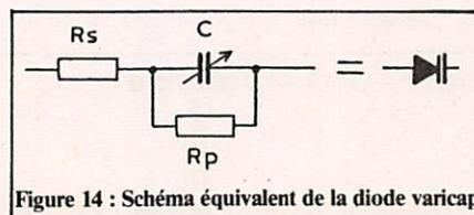
Figure 14 : Schéma équivalent de la diode varicap
