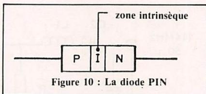
Figure 10 : La diode PIN
