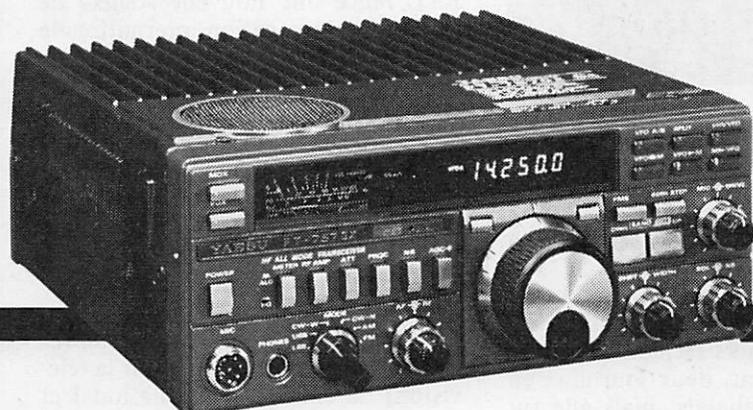
Transceiver décimétrique à couverture générale de 150 kHz à 30 MHz en réception, émission bandes amateurs. Tous modes. 100 W. Alimentation 13,8 Vdc. Dimensions 238 x 93 x 238 mm. Poids 4,5 kg. Option interface de télécommande pour APPLE II.
