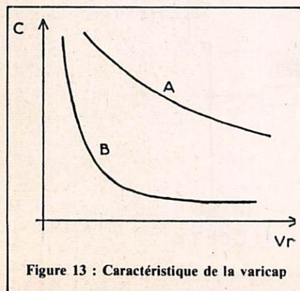
Figure 13 : Caractéristique de la varicap
