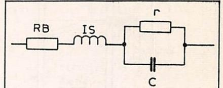
Figure 18 : Schéma équivalent de la diode tunnel
