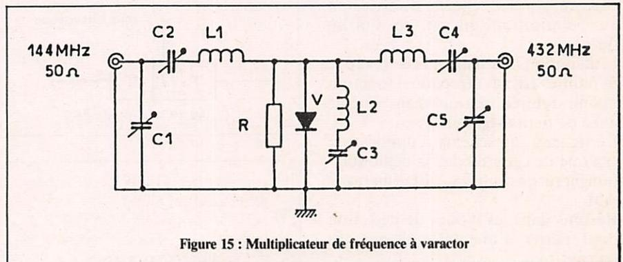
Figure 15 : Multiplicateur de fréquence à varactor
