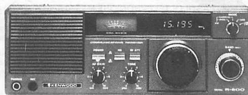
Récepteur R 600 Couverture générale 200 kHz à 30 MHz. AM/CW/USB/
