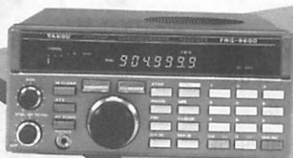
FRG 9600 Récepteur scanner de 60 MHz à 905 MHz, tous modes, 100 mémoires, 13,8 V. Option interface APPLE II.
