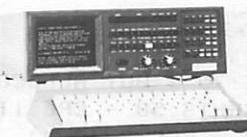
**TONO - 5000E.** Codeur-décodeur pour émission-réception en CW, RTTY (Baudot & ASCII) et AMTOR.
