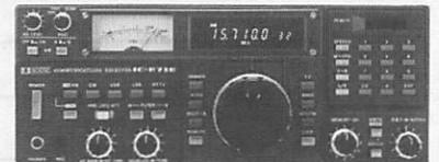
**ICOM - ICR 71E.** Récepteur tous modes de 100 kHz à 30 MHz, modes SSB/AM/RTTY/CW en option. De nombreuses innovations techniques.
