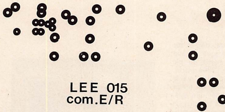
Ampli - Dessus côté composants
