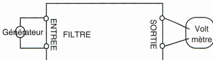
Figure 1: Un générateur à fréquence variable et tension constante est raccordé à l'entrée d'un filtre dont on mesure la tension de sortie
