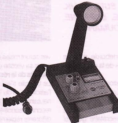
Il a été conçu pour son utilisation spécifique dans le secteur des communications et possède un amplificateur à gain élevé (35 dB) avec un compresseur de dynamique qui le rend différent des microphones traditionnels utilisés jusqu'à présent. Le niveau de sortie élevé, réglable, est capable de moduler pleinement n'importe quel type d'émetteur. Le timbre est exceptionnel. Le ROGER BEEP et l'écho sont tous deux équi-
