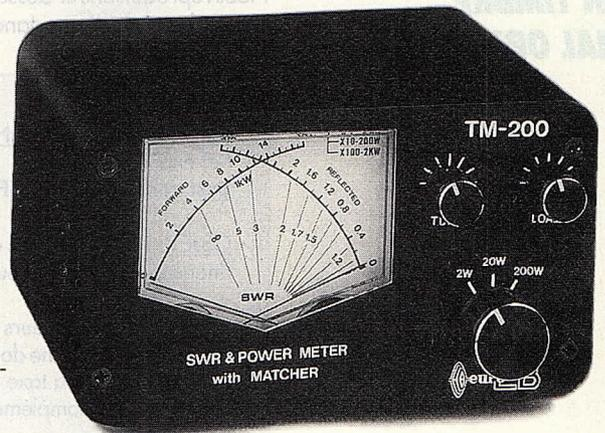
Le croisement des deux aiguilles, permet de lire le tos sur une autre échelle. Il est possible également de faire l'accord antenne poste grâce aux boutons Tune et Load et de rayonner ainsi une bonne partie de la puissance avec les réglages obtenus.
