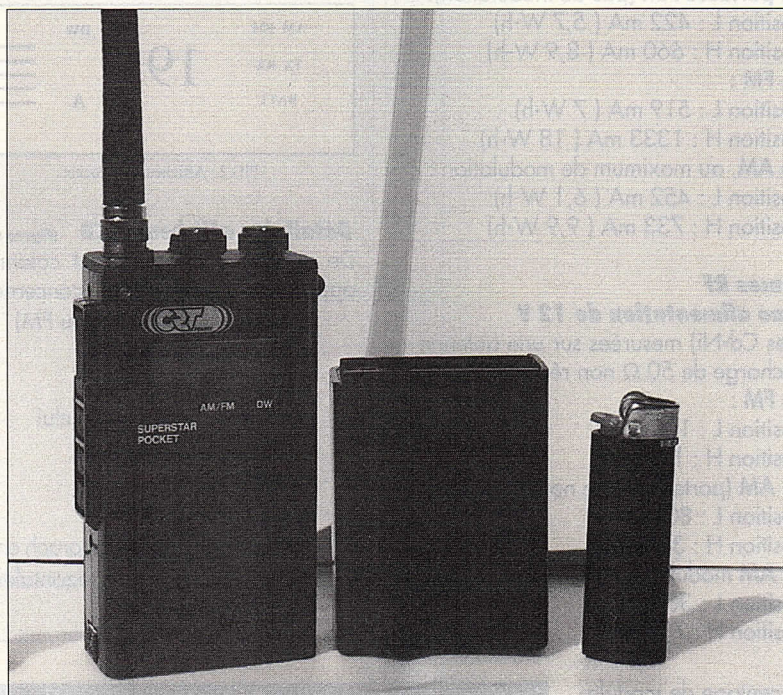
TX et boîte à piles
