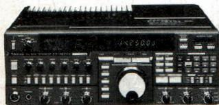
**YAESU - FT 757GXII.** Transceiver décimétrique nouvelle technologie, couverture générale de 500 kHz à 30 MHz en réception, émission bandes amateurs. Tous modes + entrée AFSK et Packet. 100 W. Alimentation 13,8 Vdc. Dimensions 238 x 93 x 238 mm, poids 4,5 kg. Option interface de télécommande pour Apple II ou RS 232C et cartouche MSX.
